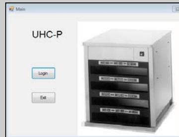
3. La ventana de configuración se mostrará en pantalla. Los menús están preinstalados. Haga clic en el icono del armario para visualizar las configuraciones de armario. **Para obtener instrucciones de funcionamiento detalladas, consulte el manual.**
