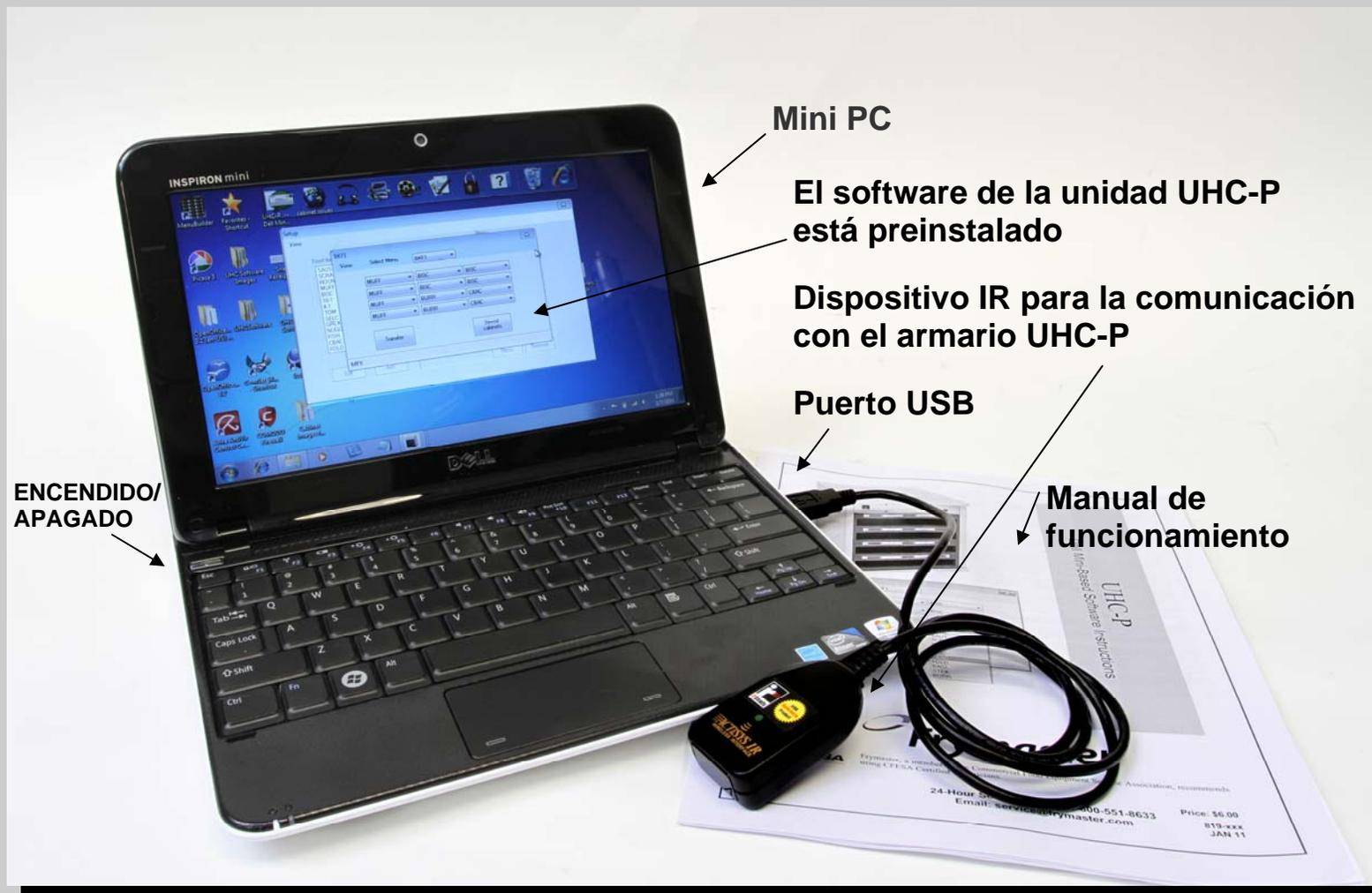
El ordenador y el dispositivo de infrarrojos están especialmente configurados para comunicarse con el gabinete de UHC-P. Estos dispositivos están configurados específicamente a disposición exclusivamente de Frymaster. Desde un punto de vista operativo, el programa informático mini es idéntico al utilizado en el programa Palm Pilot 2006 a 2010.
