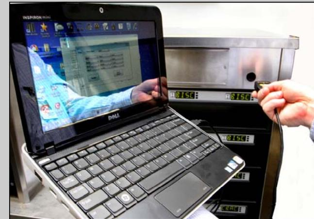
5. Haga clic en el botón de transferencia en la pantalla del menú y seguidamente coloque la llave sobre la lente del armario. Un cuadro de diálogo aparecerá en pantalla indicando que la transferencia se ha realizado correctamente.
